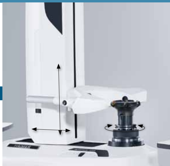
Полностью автоматическая предварительная настройка и измерение инструмента Fully automatic tool presetting and measurement independent of the operator
